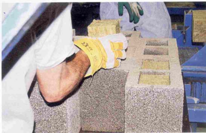
Bereits auf dem Produktionsband werden die Hohlräume der Steine mit Dämmstoff gefüllt
